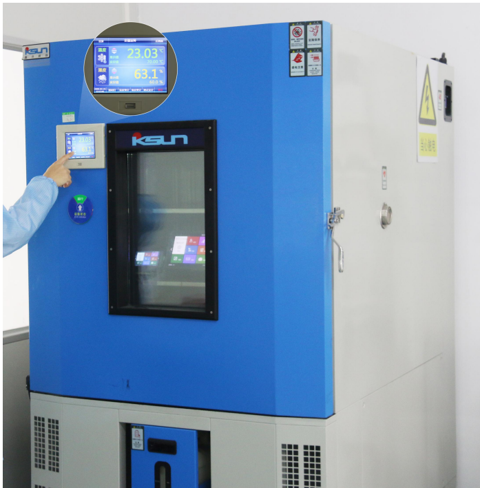
图 5-3 高低温老化测试图
